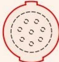
**Einsatz:** Stecker- und Buchseneinsatz kann in alle 3 Gehäuse montiert werden.
