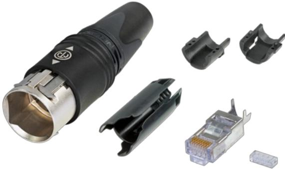
Das Kabelstecker-Set NE8MC6-MO beinhaltet ein robustes Kabelsteckergehäuse aus Metall mit einem Push Pull Verriegelungssystem, bewährter Neutrik Spannzangen-Zugentlastung und einen CAT6 RJ45 Stecker. Dieser ist für STP und UTP Kabel mit einem Kabeldurchmesser von 5.5 bis 6.5 mm und Draht oder Litzen mit AWG28 bis 22 geeignet. Diese Selbstanschluss-Variante ist wassergeschützt gemäss IP65.
