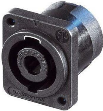
4-poliger Einbaustecker, schwarzer D- Form Flansch, Gewindelöcher für A-SCREW, 3/16" Flachsteckzungen
