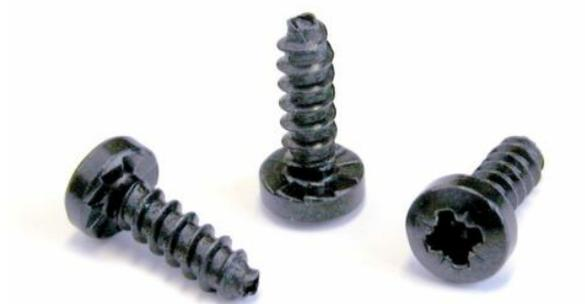
PLASTITE® selbstschneidend, dreieckförmige Konfiguration; 2,9 x 1,05; 8 mm lang, schwarz, Linsenkopfschraube
