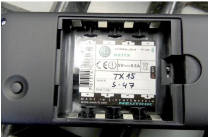
**Bild 5:** Als Stromversorgung dienen vier 1,5 Volt AAA Batterien; rechts im Bild ist der kleine Schiebeschalter zur Zuschaltung der Phantomspannung für Kondensatormikrofone zu sehen
