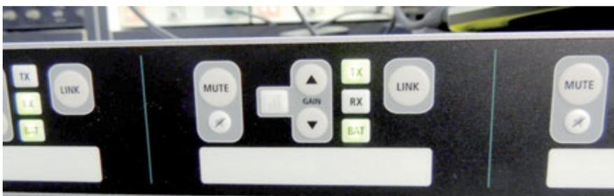
Bild 2: Eine Kanaleinheit mit der als Folientastatur ausgeführten Frontgestaltung
