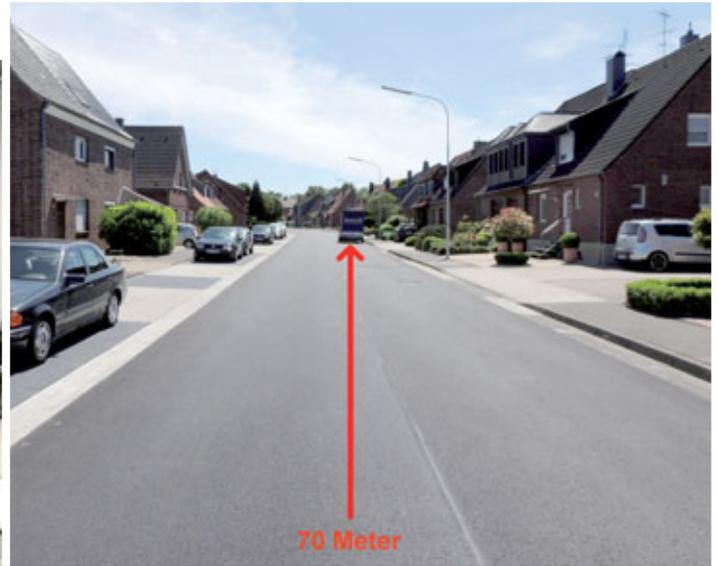
**Bild 12:** Die maximale Reichweite bei freier Sicht zwischen Sender und Empfänger betrug im Test etwa 70 Meter
